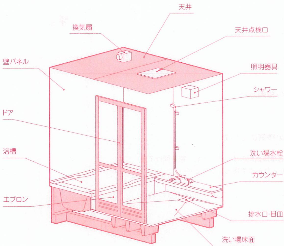
この図は、システムバスの組み合わせの一例です。システムバスは機種によって組み合わせ(各部の仕様)が異なりますので、予めご了承ください。
