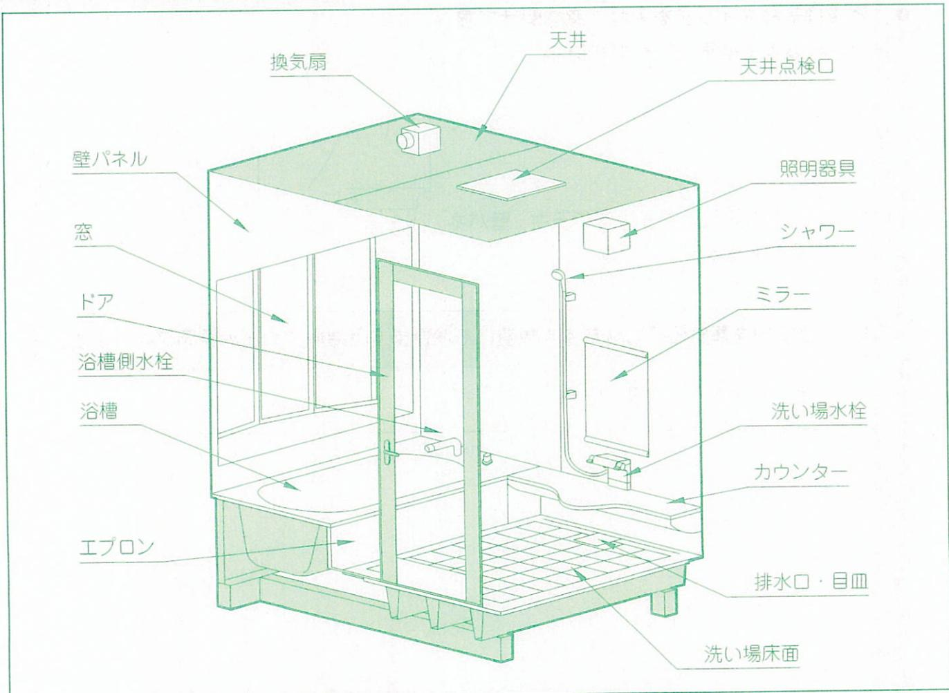
この図は、システムバスの組み合わせの一例です。システムバスは機種によって組み合わせ(各部の仕様)が異なりますので、予めご了承ください。
